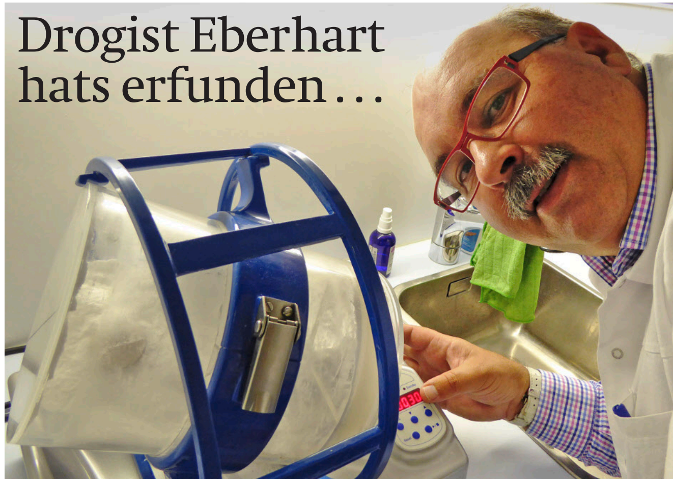
Drogist Peter Eberhart in seinem Labor. Hier werden die Schüssler-Salze im kleinen Rhönrad zerrieben und gemischt.
